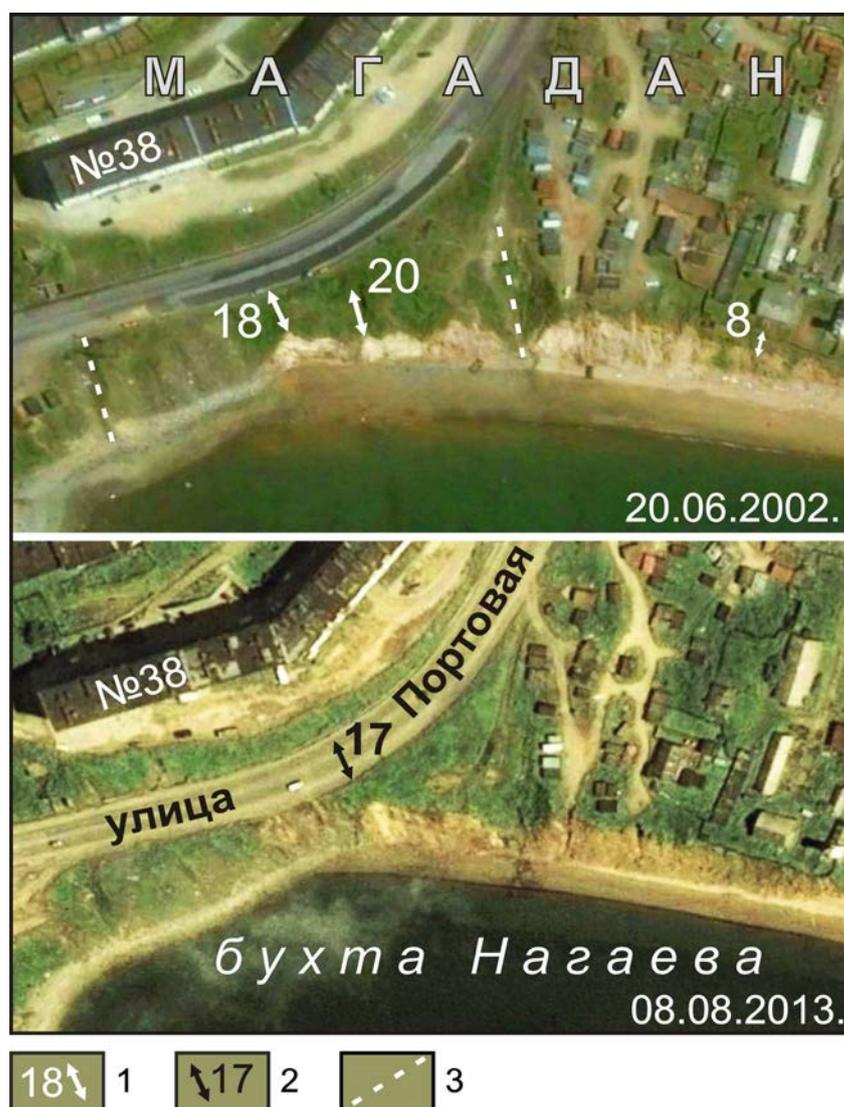
**Рис. 29.** Отступление склона в сторону суши на северном фланге Восточного клифа Нагаевской бухты за период с 2002 по 2013 г. 1 – ширина берега в метрах, уничтоженного обвально-оползневыми процессами за 11 лет; 2 – ширина дороги с обочинами; 3 – ручьи
