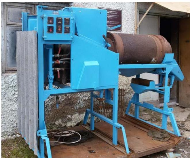
**Рис. 25.** Промывочная установка ПОУ-4М, входящая в состав геологоразведочного комплекса ПГРК-1.
