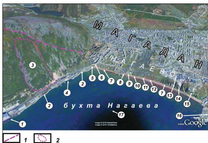
Рис. 9. Вершина бух. Нагаева: 1 – сброс, секущий склон Нагаевской сопки; 2 – контур блока отседания. 1 – морской торговый порт; 2 – каменная отсыпка; 3 – скальный блок отседания над Портовым шоссе (размерами 800×460 м); 4 – причалы Портофлота; 5 – подпорная стенка у дома № 38 по ул. Портовой, рухнувшая летом 2007 г., при сходе малого оползня; 6 – микрорайон Моргородок; 7 – клиф восточного берега Нагаевской бухты, сложенный слабо литифицированными алевролитами и аргиллитами миоценовой нагаевской толщи; 8 – здание ГИМС; 9 – видовая площадка с лестницей, спускающейся на пляж; 10 – обвал-оползень НК-0.00075, образовавшийся в октябре 2003 г.; 11 – оползень НК-0.014, возникший осенью 2006 г.; 12 – оползень НК-0.003, возникший весной 2006 г., и оползень НК-0.0018, появившийся осенью 2009 г. на месте предыдущего; 13 – завод стройматериалов; 14 – оползень НК-0.0006, возникший летом 2009 г.; 15 – инфекционная больница; 16 – микрорайон Марчекан, рыбный порт и судоремонтный завод; 17 – затонувший весной 2006 г. БМРТ «Профессор Моисеев». Соотношение вертикального и горизонтального масштабов космоснимка (сервис Google Earth) 3:1
